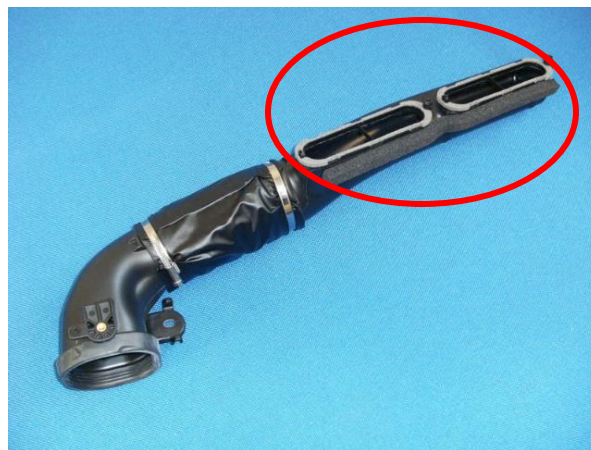
Imagen 4 Dirty Side Duct, Boplas
