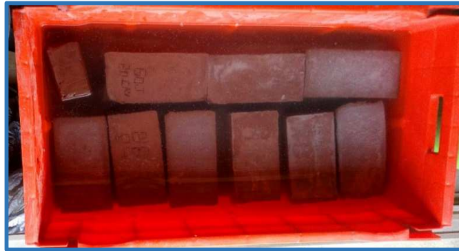
Figura 4.8 Ladrillos en el proceso de curado
