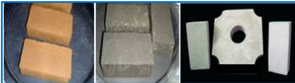
Figura 2.2 Ladrillo y celosías hechos a partir de jales (AG Roadway Products, 2012; Vite, et al 2005)
