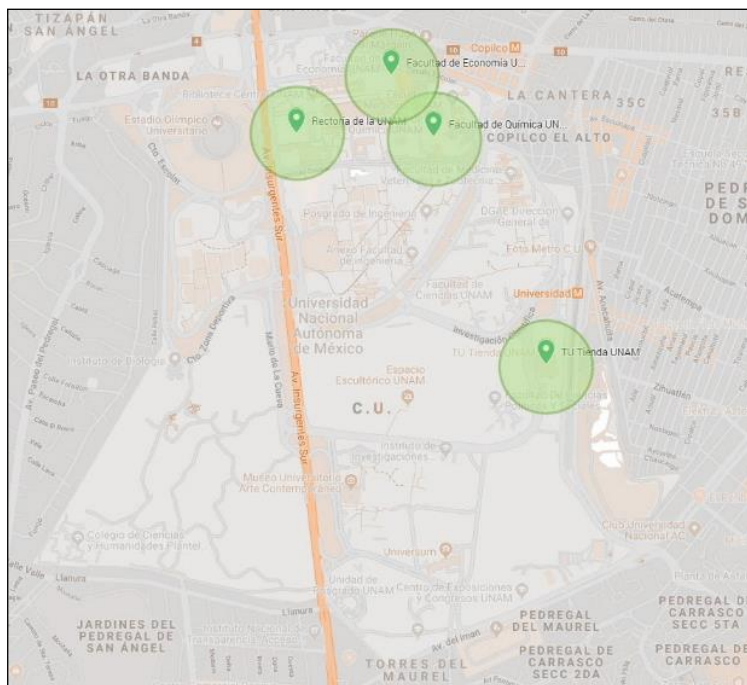
Figura 19. Representación del radio de cobertura de 500 m para solución dada por el modelo de máxima cobertura utilizando la red de conexiones para cuatro ambulancias. (Fuente: Elaboración propia, 2019).
