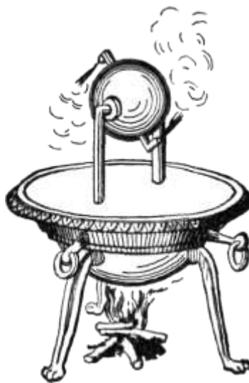
Figura 1. Primera turbina de vapor [Fuente: Naturaleza Educativa (2019) Eolípilo de Herón . Recuperado de: https://natureduca.com/tecnologia-aeronautica-propulsion-e-instrumentacion-03.php ]
