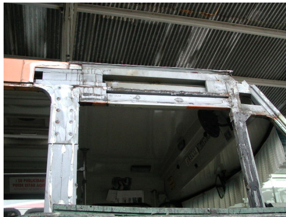
Figura 4-2. Región de la localización de la falla.
