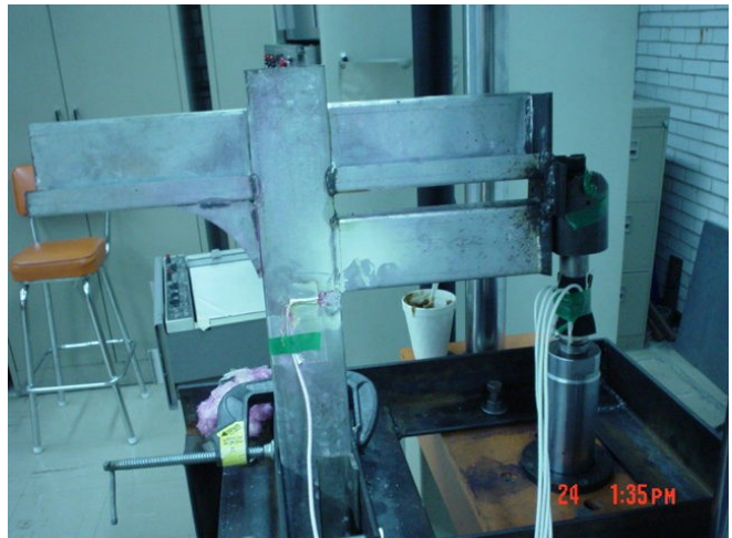
Figura 4-15a. Máquina con marco de carga. Figura 4-15b. Probeta montada en la maquina.
