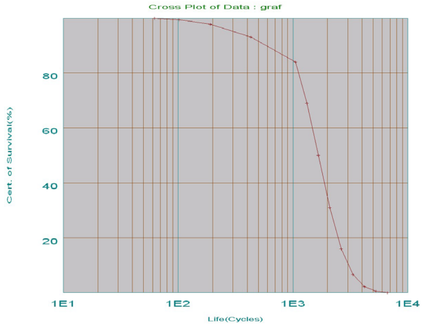
Figura 4-12. Gráfica para la predicción de ciclos corregida.
