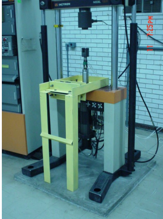
Figura 4-14. Máquina servohidráulica con mordazas.
