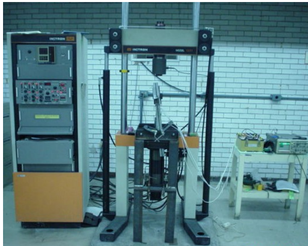
Figura 4-15a. Máquina con marco de carga. Figura 4-15b. Probeta montada en la maquina.
