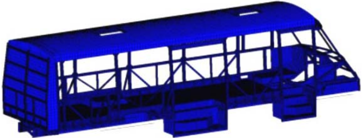
Figura 4-4. Salida gráfica de la estructura del autobús modelada por elemento finito.
