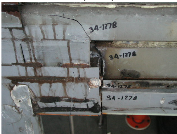
Figura 4-3. Punto de inicio de la falla y trayectoria.
