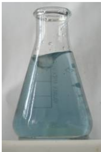
Figura 19. Coloración de la muestra de colorante a los 10 minutos de haber agregado el reactivo de Fenton.
