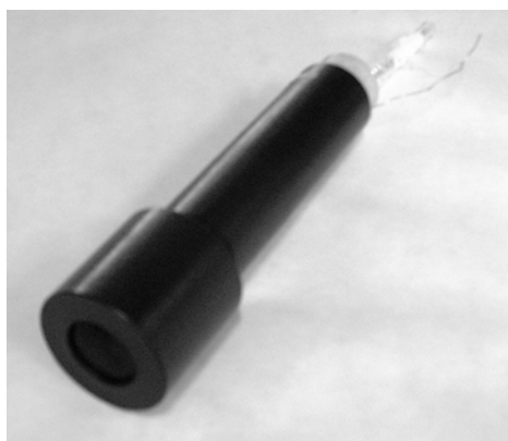
Figura 13. Cátodo de difusión de oxígeno
