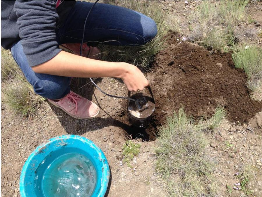
Figura 4.4 – Colocación de un electrodo en campo.
