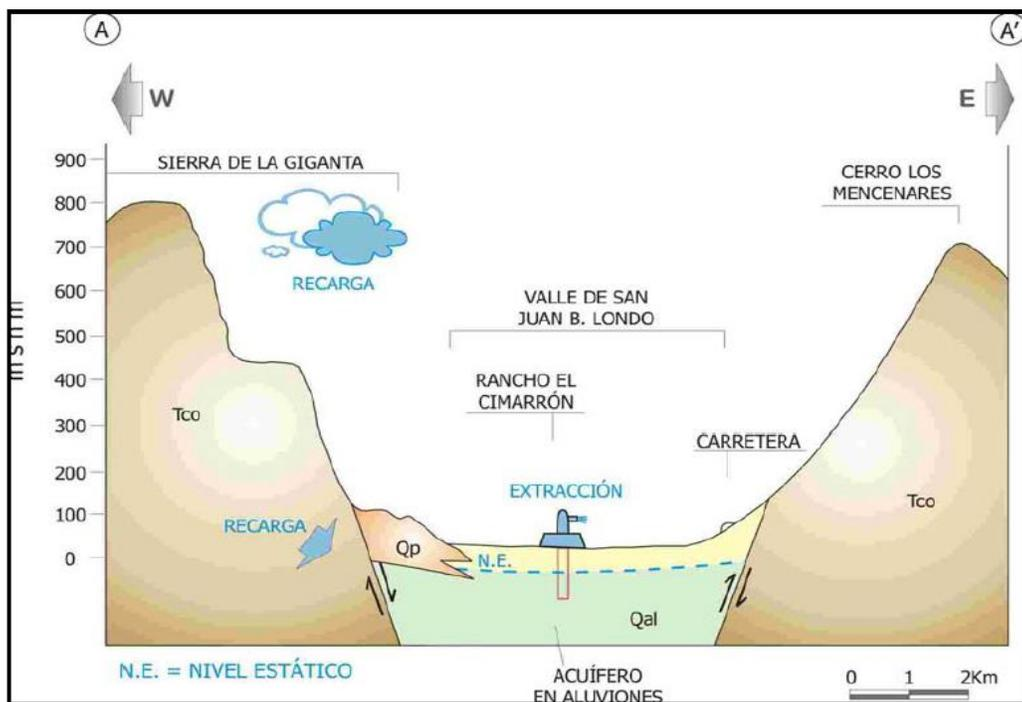
Figura 2.5 – Sección geológica esquemática que muestra el funcionamiento del acuífero (CONAGUA, 2015).
