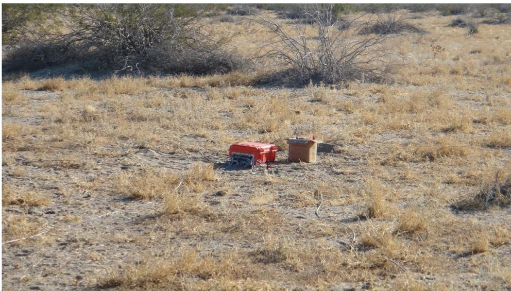
**Figura 4.5 – Consola ADU-07e instalada en campo.**
