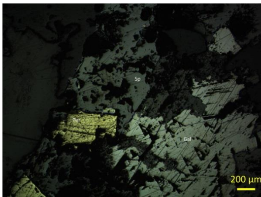
Ilustración 4. -aglomeración de primera generación cristalina de pirrotina (Pirr), esfalerita (Sp) y galena (Gal). reemplazando calcita. NPL. 20x
