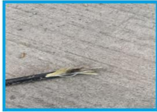
Figura 14. Corte de Fibra derivado de una poda de árbol.
