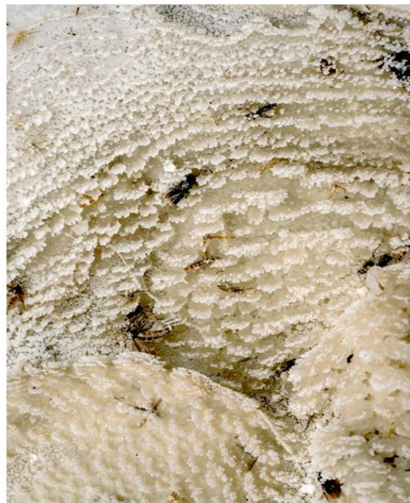
Figura 22. Fotografías de incrustación de precipitación de sílice en la descarga de un fluido hidrotermal en Los Humeros, donde se observa una textura coliforme con atrapamiento de insectos.
