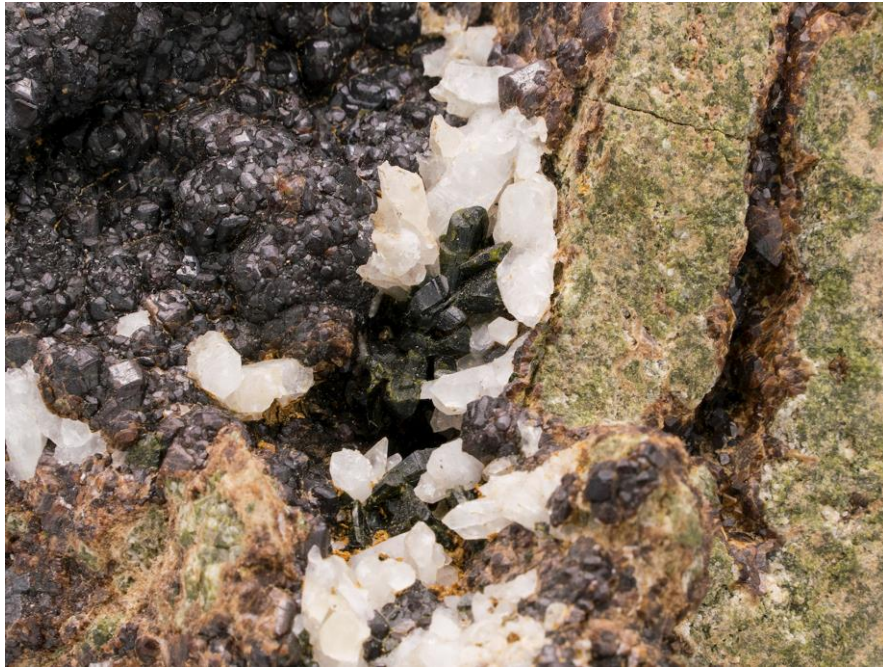
Figura 12. Zona de Skarn típica con calcita (min. Blanco) + Anfíboles (min. Verde)+grossularita (min. café) del Distrito minero de Tatatila Las Minas, Ver., y basamento local de Los Humeros
