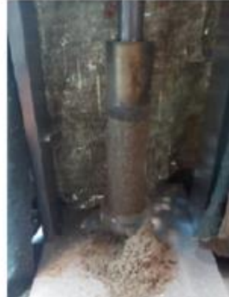
Figura 3.3 Procedimiento de labrado, Instituto de Ingeniería de la UNAM
