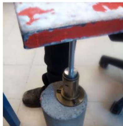
Figura 3.8 Escarificado y Compactado del material, Instituto de Ingeniería de la UNAM
