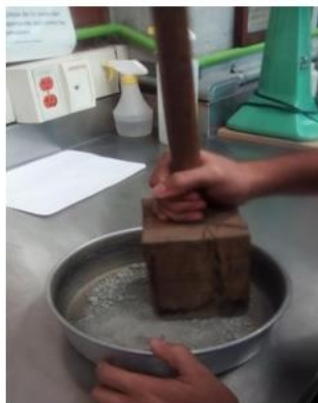
Figura 3.4 Disgregación del material, Instituto de Ingeniería de la UNAM
