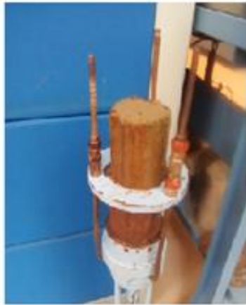
Figura 3.3 Procedimiento de labrado, Instituto de Ingeniería de la UNAM
