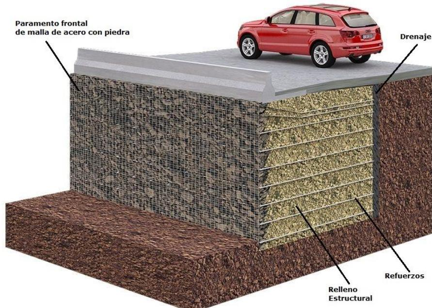
Ilustración 2. Diagrama de muro mecánicamente estabilizado.
