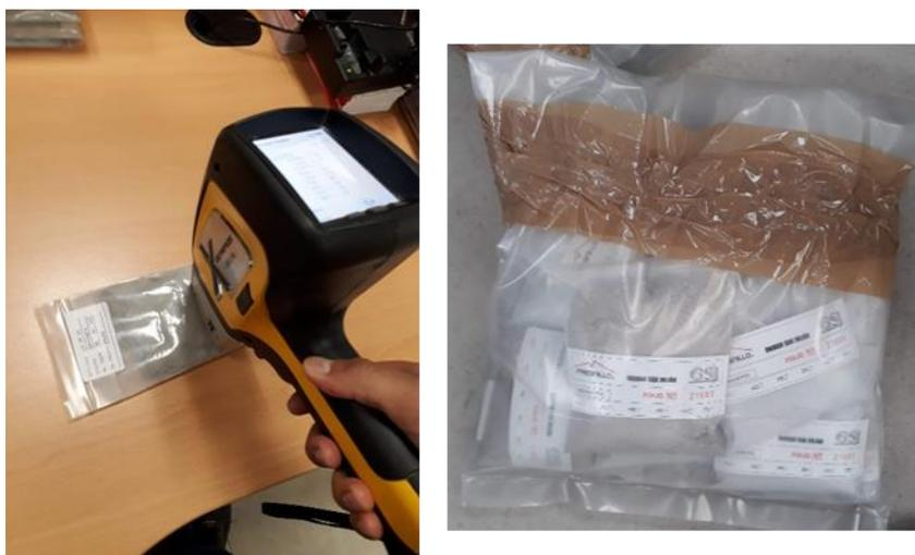
Fotografía 4.- A la izquierda se muestra el análisis con el XRF Olympus Delta, a la derecha se muestra el empaquetamiento de tercerías.
