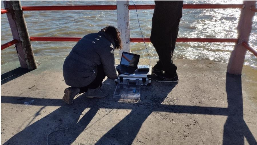
**Figura 3.5:** Fotografía de la captura de la muestra con el software Ocean View del espectro radiómetro.
