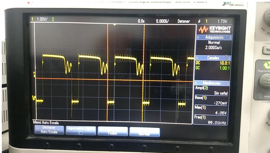
Figura 97 Ciclo de trabajo del cargador de baterías.
