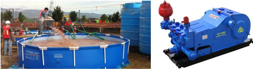
Figura 1-10 Tanque de mezclado y bomba de lodos
