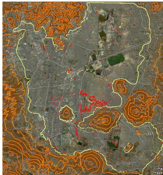
Figura 4-11. Agrietamientos en rojo para zona del ex Lago de Texcoco (extraída de SIG en el programa informático Google Earth v.6.0. (Mendez et al., 2008)
