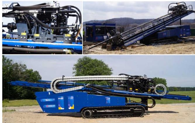
Figura 4-17. Perforadora con Barreno Auger Boring, modelo DD-440T. (Imagen tomada de *American Augers*)
