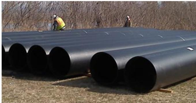
Figura 4-1. Tubería X-52 de acero al carbón
