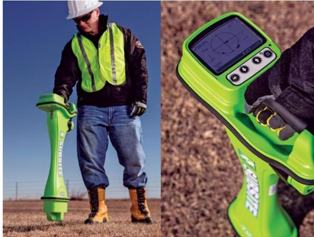
Figura 3-11. Receptor del sistema “Walkover” (Imagen tomada de Trenchless Technology)
