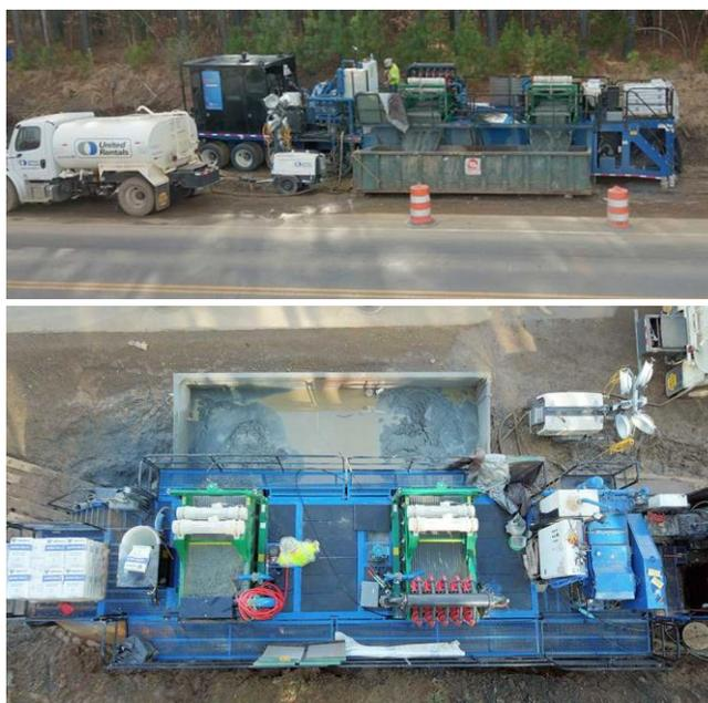
Figura 4-17. Sistema de Control de sólidos Cleaning System American Augers, modelo M-500PD. (Imagen tomada de American Augers)
