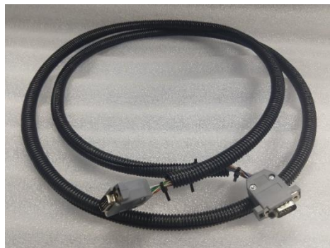
Figura 66: Cable UTP forrado con manguera ranurada, asegurado con cinturoncillos de nylon. En sus extremos se une a conectores DE-15 macho.
