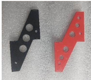
ANEXO A - Figura 3: Paleta del carrusel. A la izquierda la pieza de la versión anterior; a la derecha la nueva pieza.
