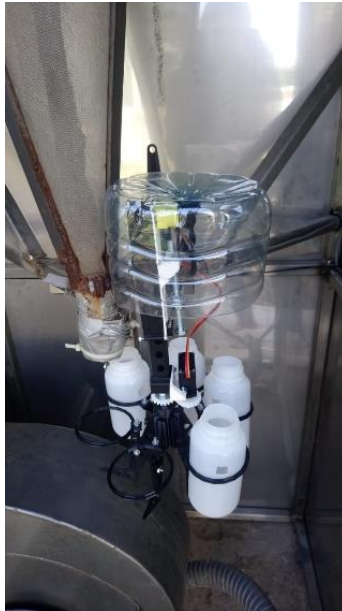
Figura 2: Última versión probada del intercambiador automático de muestreo, antes de comenzar con la presente investigación. Fotografía tomada por personal del INIFAP.
