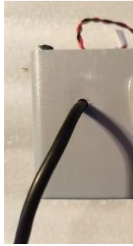
Figura 73: Cable que atraviesa una pared de la caja para alimentar a la SBC.
