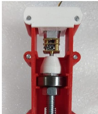
ANEXO B - Figura 2: Porta - micro - motorreductor, micro - motorreductor, y su cople, ensamblados al intercambiador.
