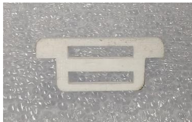
ANEXO C - Figura 2: Pieza para limitar el movimiento de las piezas para sostener los sensores de efecto Hall de tipo lineal.
