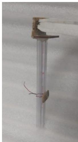
Figura 51: Prototipo de las piezas para sostener los sensores de efecto Hall de tipo lineal, se sostiene de la tapa a diferentes distancias, los sensores se colocan en una barra donde se deslizan vertical y horizontalmente para finalmente ajustarse.
