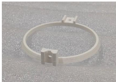
ANEXO C - Figura 5: Aro sujetador del frasco de recolección modificado para poder introducir el imán. Vista desde abajo.
