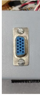
Figura 67: Conector DE-15 hembra.
