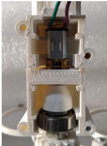
ANEXO C - Figura 6: Caja para micro - motorreductor que gira al carrusel, ensamblada al intercambiador.
