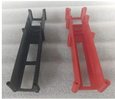
ANEXO A - Figura 9: Guía - porta motor. A la izquierda la pieza de la versión anterior; a la derecha la nueva pieza.
