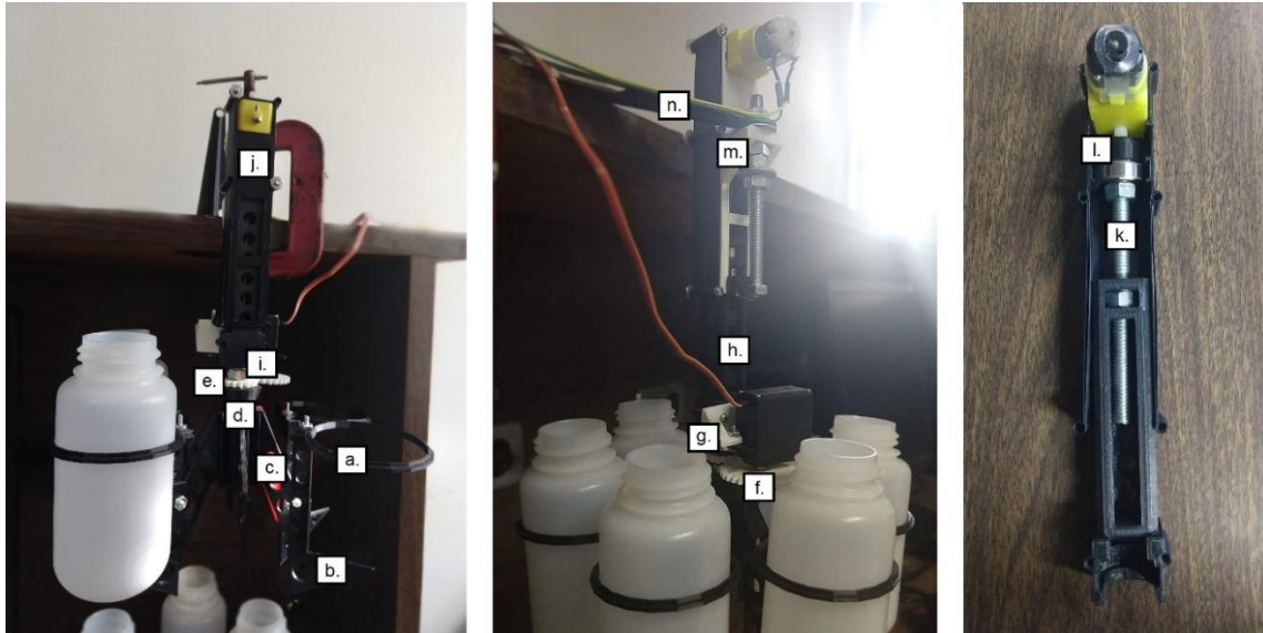
Figura 3: Piezas de la versión que falló del intercambiador automático de muestreo. Las letras coinciden con la lista en el texto.
