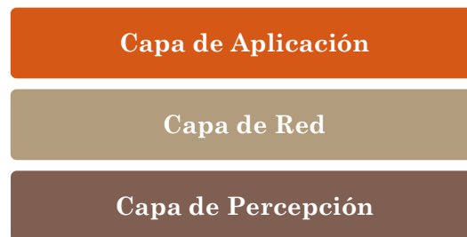
Figura 5: IoT en 3 capas. Diagrama elaborado a partir de la información obtenida en (Sethi & Sarangi, 2017) y (Al-Qaseemi, Almulhim, Almulhim, & Rasool, 2016).
