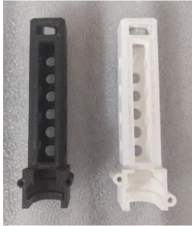
ANEXO A - Figura 8: Émbolo. A la izquierda la pieza de la versión anterior; a la derecha la nueva pieza.
