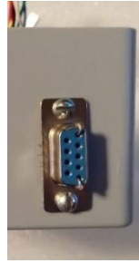
Figura 70: Conector DE-9 hembra para sensores. De izquierda a derecha: BMP180, DHT11. Se inhabilitan físicamente dos pines del conector para evitar equivocación al conectar.
