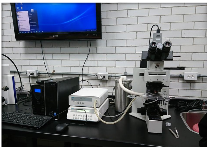
Figura III.9. Equipo para estudio microtermométrico LINKAM.
