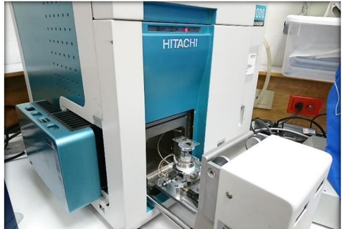
Figura III.8. Equipo HITACHI TM-1000 utilizado en el análisis MEB.
