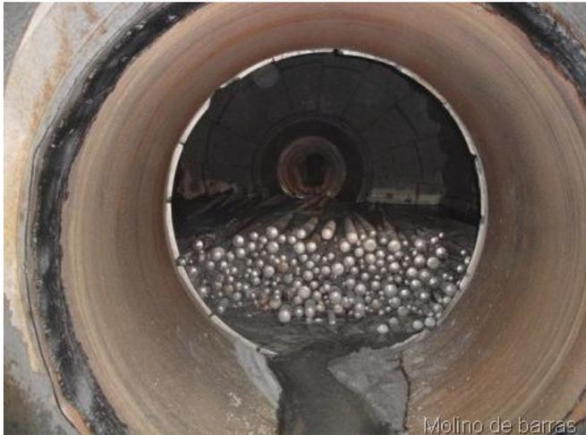
**Figura 1.9.2.1 Vista interna de un molino de barras (Procesamiento de minerales).**
