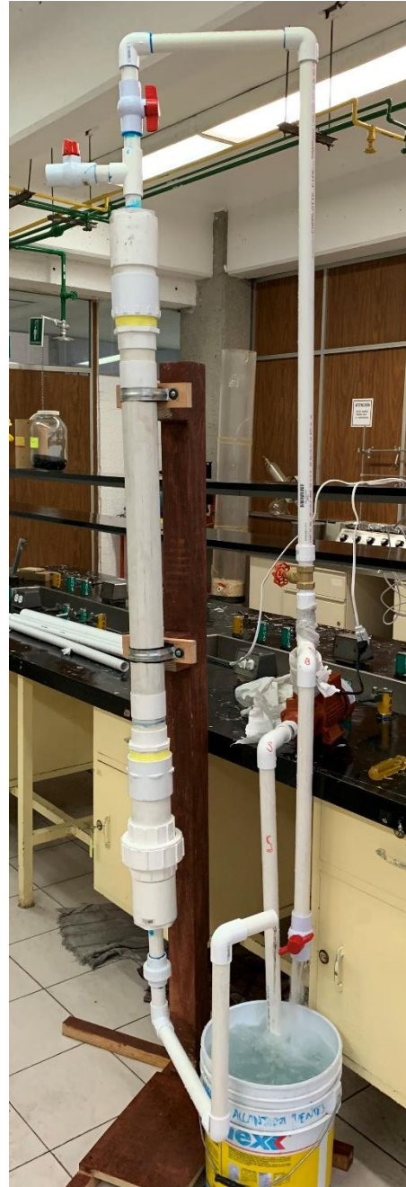
Figura 7.7 Instalación del sistema de filtración en el laboratorio. Fuente: Directa (2019)
