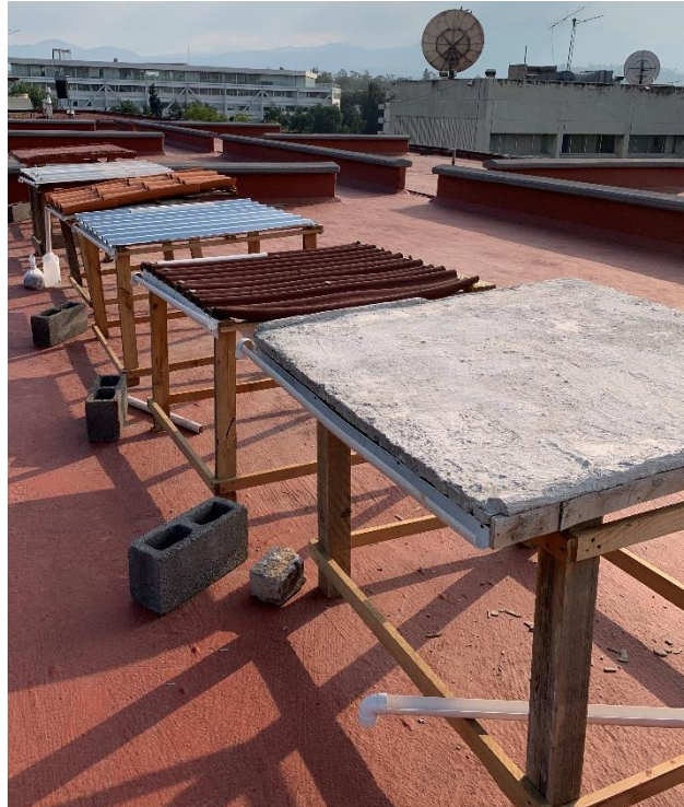
Figura 7.6 Superficies de captación de agua de lluvia instaladas en el edificio U de la FI UNAM. Fuente: Directa (2019)
