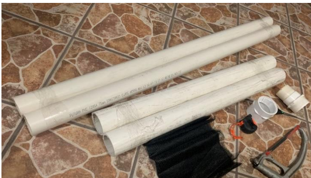
Figura 6.3 Parte de los materiales y herramientas usadas para la elaboración de la estructura confinante del filtro dual. Fuente: Directa (2019)
