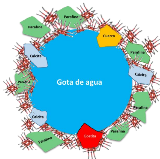
Figura A.11 Esquema de una emulsión agua en aceite (W/O). Las partículas rojas son moléculas de aceite unidas por granos de calcita, cuarzo y goethita (Uetani, 2018).
