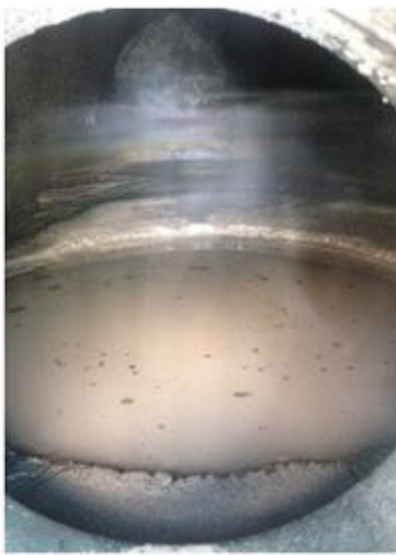
(a) Acumulación característica de arena y agua emulsionada dentro de un separador multifásico.
