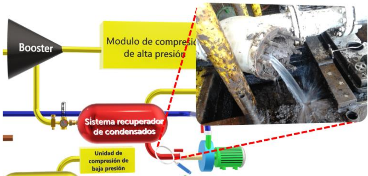
Figura 3.4 Ubicación esquemática y representativa de la problemática, extracción de «emulsión muerta».
