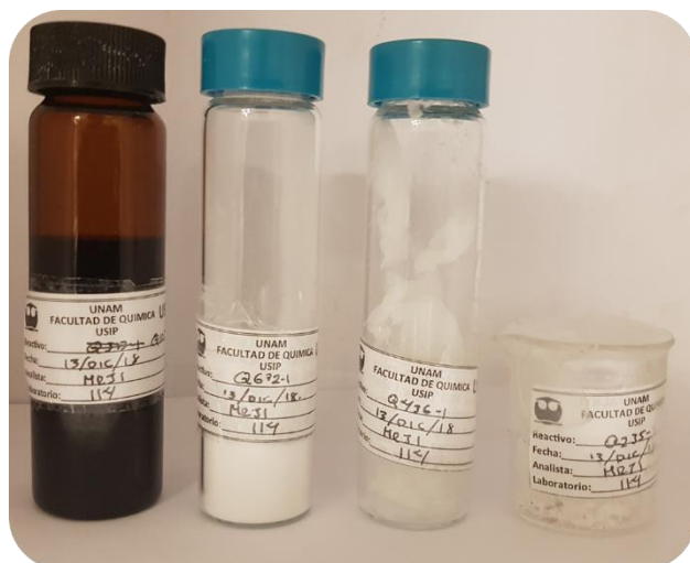
Figura 3.6 Agentes químicos utilizados para el diseño de la mezcla denominada SOIL (Surface Operator and Inhibitor Liquid). [DMEA] Dimetil-etanolamina (Q103-I), [LSS] Lauril Sulfato de Sodio (Q672-I), [AEE] Alcohol estearílico etoxilado (Q436) y [NFE] Nonil Fenol Etoxilado 30 M (Q235-I).
