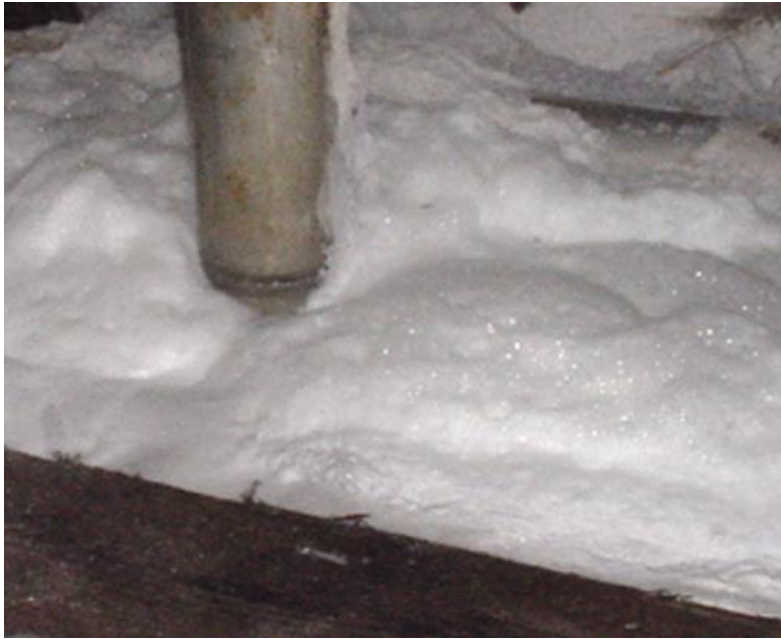
Figura A.6 Producción de espuma en los internos de un separador (Chemie, SEPAR, 2019).
