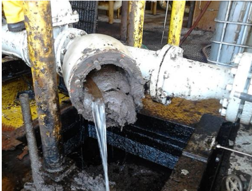
(b) Separación de fases de la emulsión por el tiempo de reposo en el sistema.
