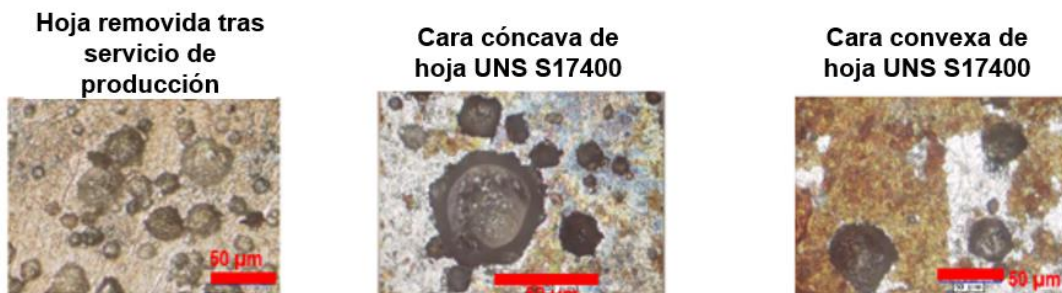
Figura A.5 Corrosión por efecto abrasivo de sales: de izquierda a derecha se observa un segmento de la hoja de álabes removida de un compresor, la parte cóncava y por último la parte convexa de la cuchilla (Srinivasan y Kelly, 2015).
