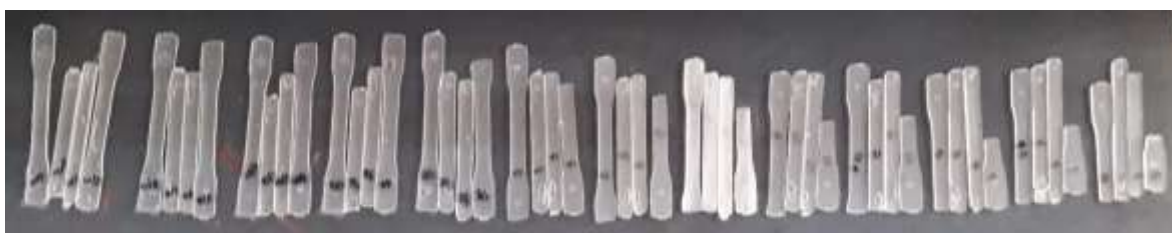
Imagen 21. Piezas obtenidas durante el estudio de curva de viscosidad
