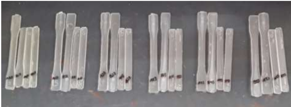
Imagen 55 Probetas obtenidas durante la ventana cosmética de proceso
