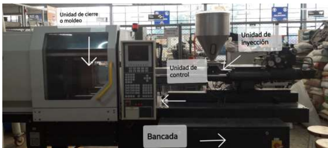
Imagen 5. Componentes de la máquina de inyección DEMAG 50/270 del Laboratorio de Procesamiento de plásticos, Facultad de Ingeniería UNAM.
