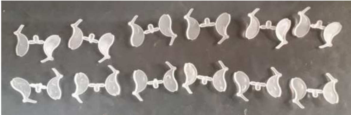
Imagen 44. Piezas obtenidas sello de compuertas molde 3
