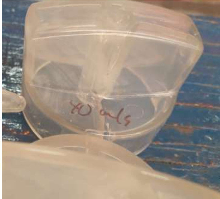
Imagen 28. Defecto de ráfagas en velocidad de inyección 40 [mm/s]
