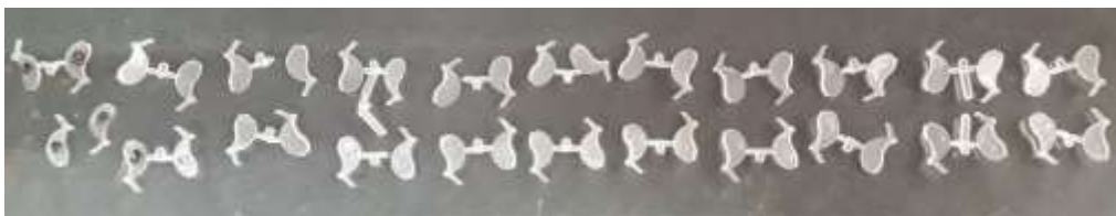
Imagen 43. Piezas obtenidas ventana cosmética de proceso molde 3
