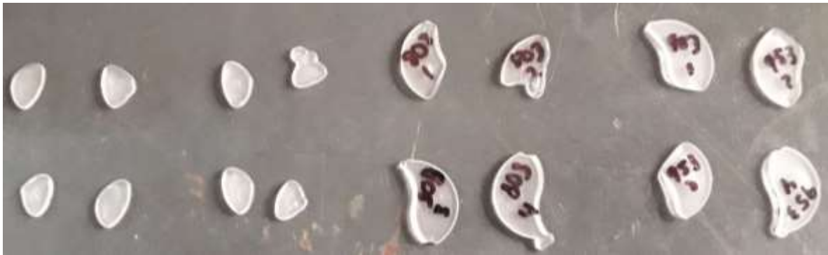
Imagen 42. Piezas obtenidas en balanceo de cavidades molde 3
