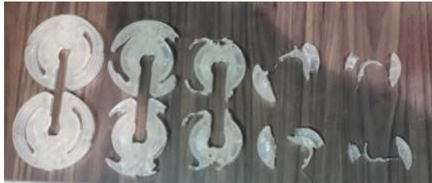
Imagen 47 Piezas obtenidas durante el balanceo de cavidades molde 4.
