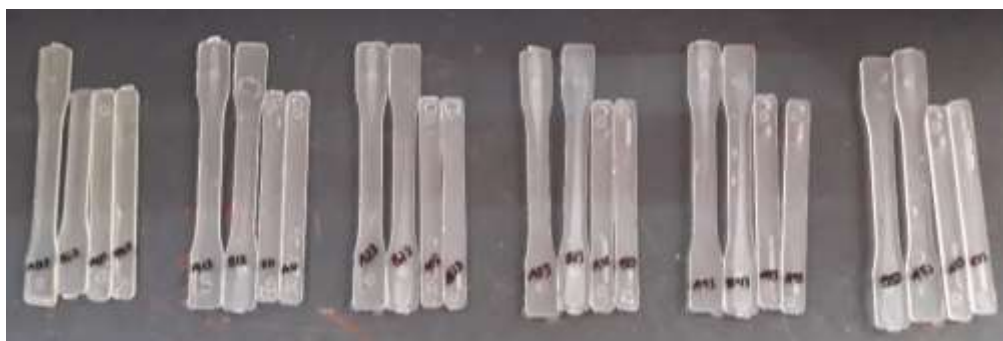
Imagen 24. Piezas obtenidas en sello de compuertas molde 1
