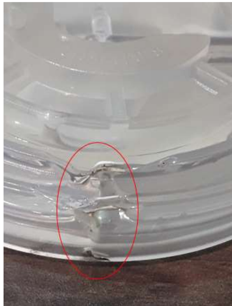
Imagen 49. Efecto Diésel en piezas a baja presión de sostenimiento
