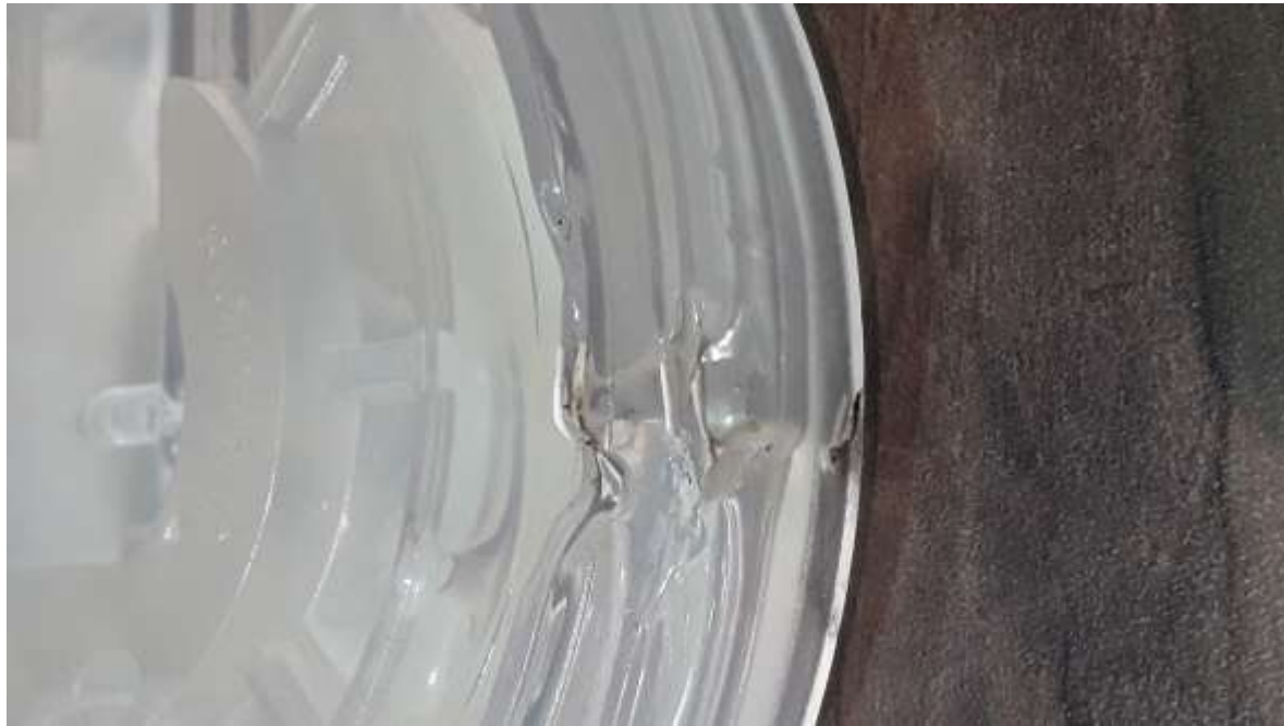
Imagen 59 Efecto Diésel en nodos durante la ventana cosmética de proceso
