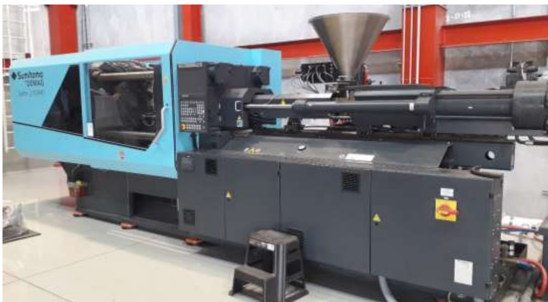
Imagen 7. Máquina de inyección Sumitomo DEMAG Systec 210/580-840 8 con capacidad de fuerza de cierre de 210 ton.
