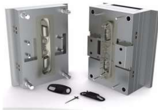
Imagen 8. Molde de inyección 10
