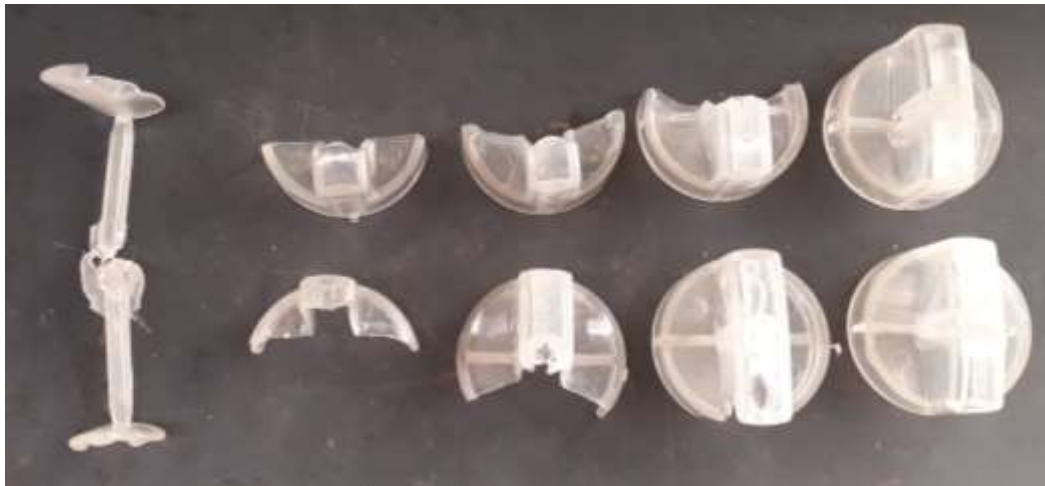
Imagen 33. Piezas obtenidas en caída de presión molde 2.
