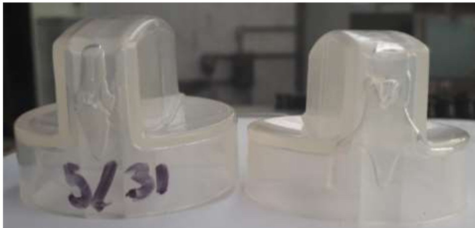
Imagen 35. Pieza inyectada con 5[s] de tiempo de mantenimiento y 59 [cm 3 ]
