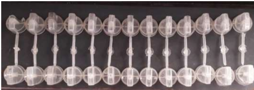
Imagen 31. Piezas obtenidas para la curva de viscosidad del molde 2
