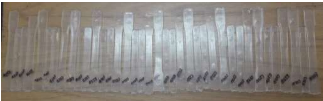
Imagen 25. Piezas obtenidas tiempo de enfriamiento molde 1
