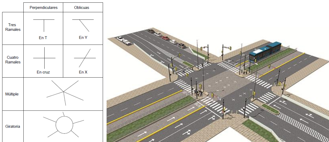
Figura 2.2: Tipología de intersecciones a nivel con ejemplo en cruz. Fuente: Ingeniería de Tránsito y Carreteras (J. Garber & A. Hoel, 2005).
