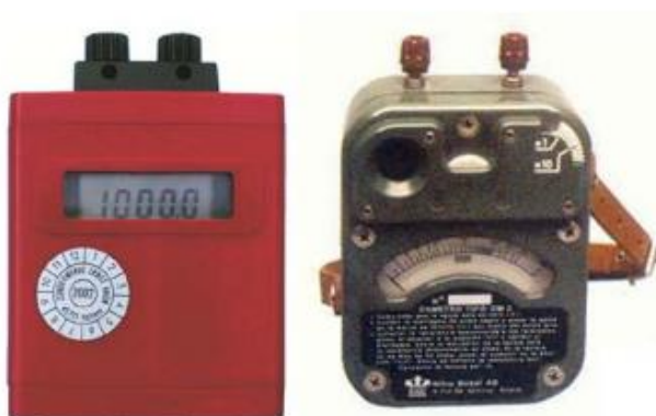
Figura 2.16 Óhmetro análogo vs. Óhmetro digital
