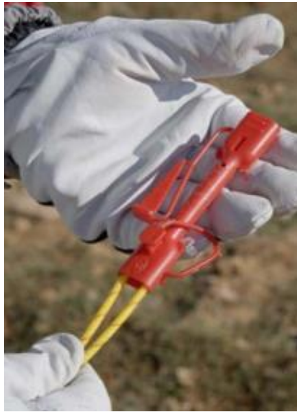
Figura 2.12 Relé de microrretardo en Perforación y voladura de rocas en minera , Universidad Politécnica de Madrid, 2013.
