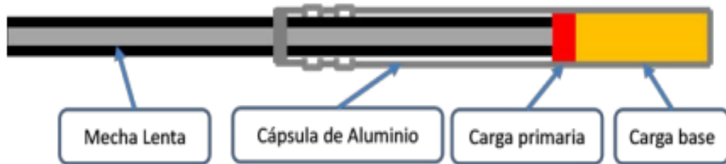
Figura 2.7 Iniciador Ordinario en Perforación y voladura de rocas en minera , Universidad Politécnica de Madrid, 2013.
