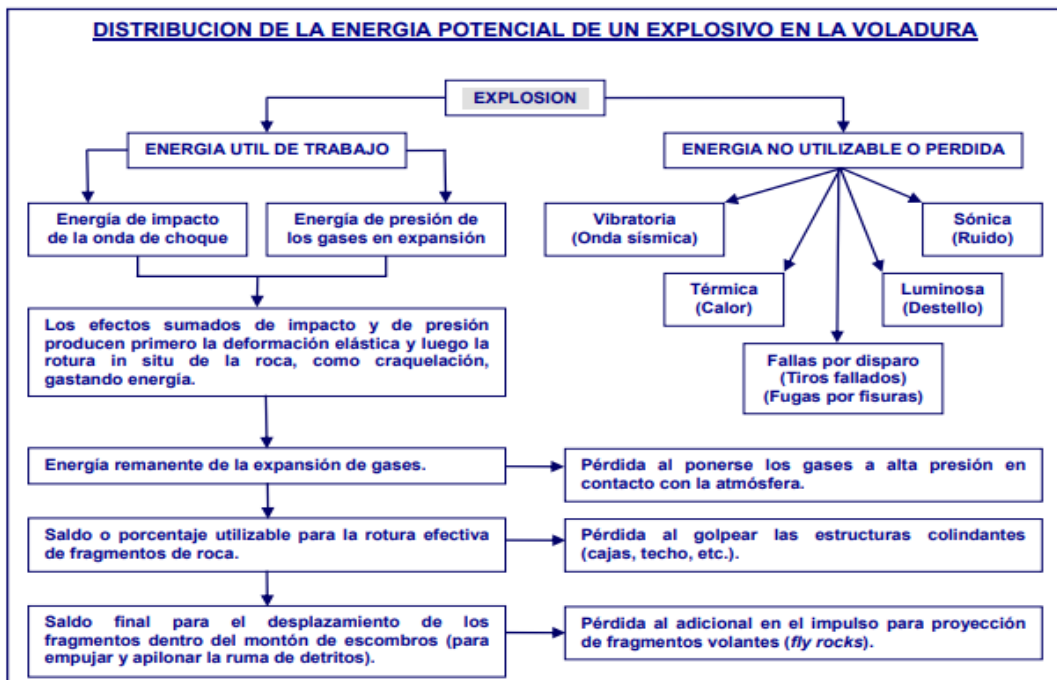
Figura 2.2 Cuadro de distribución de energía potencial del explosivo en voladura, Manual EXSA.
