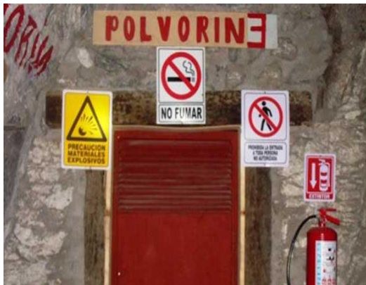
Figura 7.2 Polvorín de una mina subterránea. Revista de seguridad minera , 2010.
