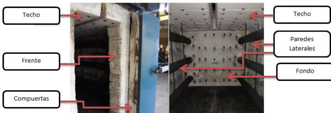
Imagen 2. 5 Superficies recubiertas de aislante
