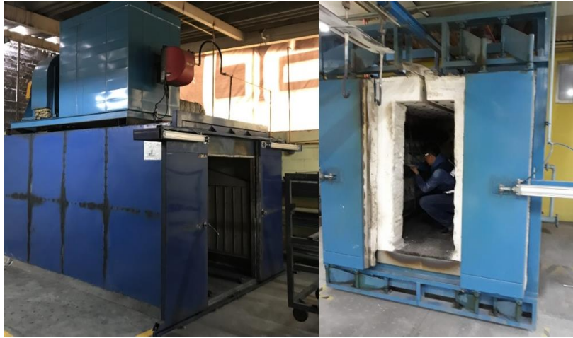
Imagen 1. 9 Horno de curado (180°C) y horno de esmalte porcelanizado (835°C)
