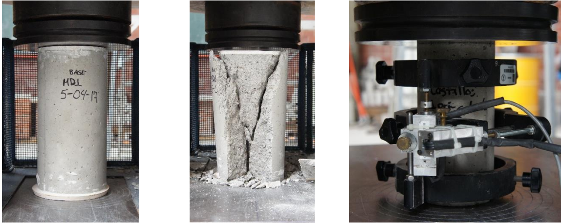
Figura A.2 Ensayo de cilindros de concreto a compresión
