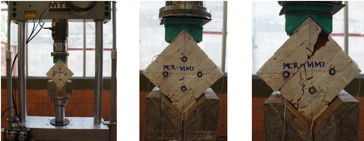
Figura A.5 Ensayo de muretes a compresión diagonal
