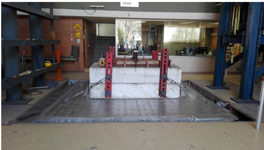
Figura 3.21 Masas para calibrar la mesa vibradora
