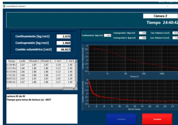
Figura 4.20. Prueba de consolidación.
