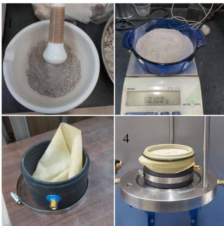
Figura 5.7. Fotografías del procedimiento de reconstitución de probetas.
