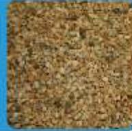
La grava sílica se produce por trituración de piedra de sílica de textura abierta, cribada a distribución de grano necesaria, es producida por trituración de molienda y lavado del sílice de alta calidad.
