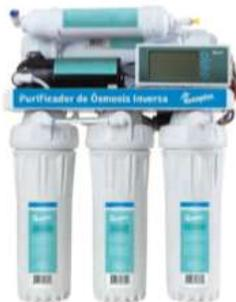
Sistema de purificación de 5 etapas; la primera etapa es una filtración con membrana de polipropileno, para eliminar sedimentos; la segunda y tercera es con carbón activado para neutralizar y eliminar sabor, olor y color del Agua; la cuarta etapa es con una membrana de ósmosis inversa y la última con carbón activado pulidor para Mejorar su calidad organoléptica.
