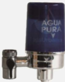
Tiene una primera etapa de filtración con una tela de 200 micras, para eliminar partículas y sólidos suspendidos, posteriormente para por carbón activado y KDF para eliminar cloro, olores, sabores químicos y metales pesados; finalmente tiene una membrana de fibras huecas de 0.1 micra para eliminar microorganismos.
