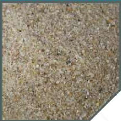
La arena de sílice se produce por trituración de piedra o arena de sílica de textura abierta, cribada a distribución de grano necesaria. La arena de sílice es producido por trituración de molienda y lavado del sílice de alta calidad.
