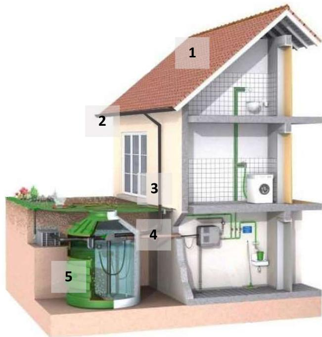
Ilustración 22 Sistema de Captación de Agua de Lluvia
