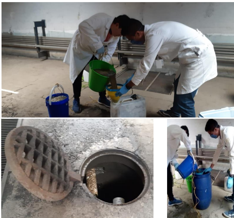
Figura 7.1 Procedimiento de muestreo en la PTAR Cerro de la Estrella
