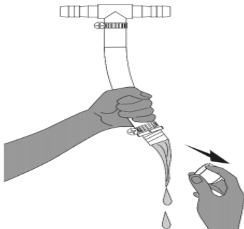
Figura 4.19. Drenado de la trampa de agua.
