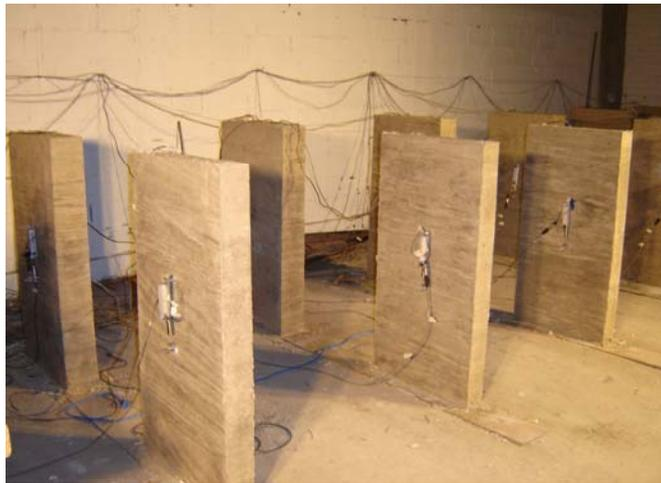
**Figura 2.12 Losas coladas y transductores de desplazamiento**
