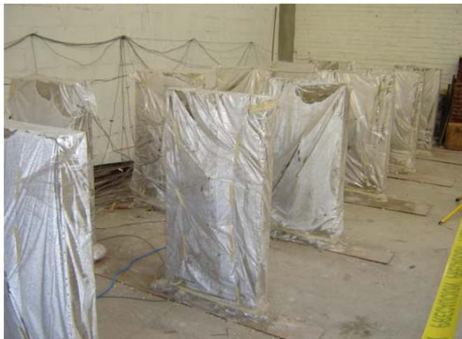
**Figura 2.13 Curado de losas**
