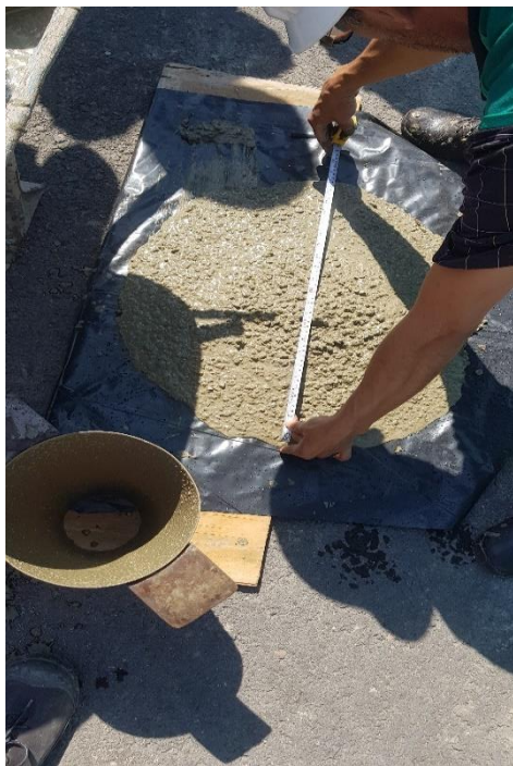
Fig. 3.20. Fotografía en la que se observa la medición de la extensibilidad del concreto.
