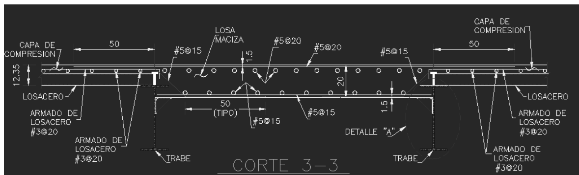
Fig. 4.8 Detalle del armado de la losa maciza en huecos de elevador y montacargas.
