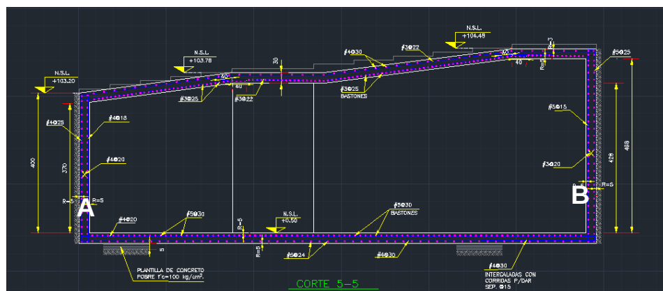
Figura 5.9. Armado de los muros en los cortes 3-3, 4-4, 5-5 en cuarto de máquinas.
