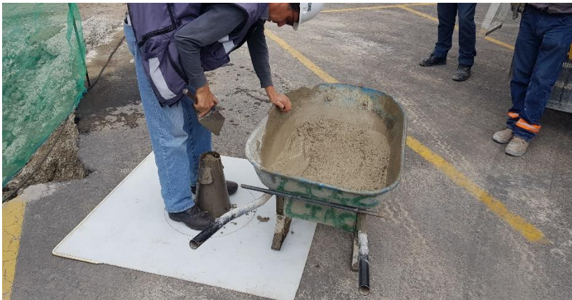
Fig. 3.19. Prueba de cono realizada por personal de laboratorio.
