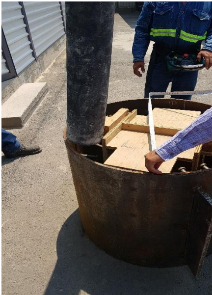
Fig. 3.15 Fotografía de la experimentación con un modelo del zuncho y una tubería flexible o "moco" de una bomba telescópica
