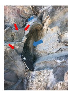
Figura 16: Sistema Matriz (roca)-Fracturas (en rojo)-Porosidad (por disolución en azul).
