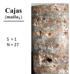
Figura 4.13: Método de conteo de cajas (malla No.1). Fotografía del núcleo de ejemplo número dos (Castro, 2019).
