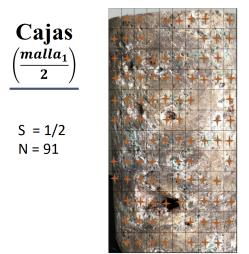
Figura 4.14: Método de conteo de cajas (malla No.2). Fotografía del núcleo de ejemplo número dos (Castro, 2019).
