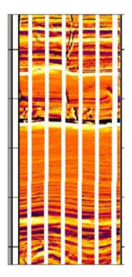
Figura 1.25: Imagen de pozo realizada con un registro de resistividad.
