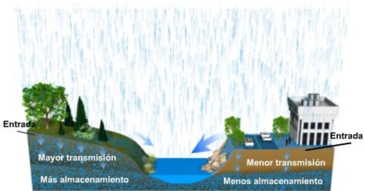
*Figura 4 Proceso de infiltración.*
