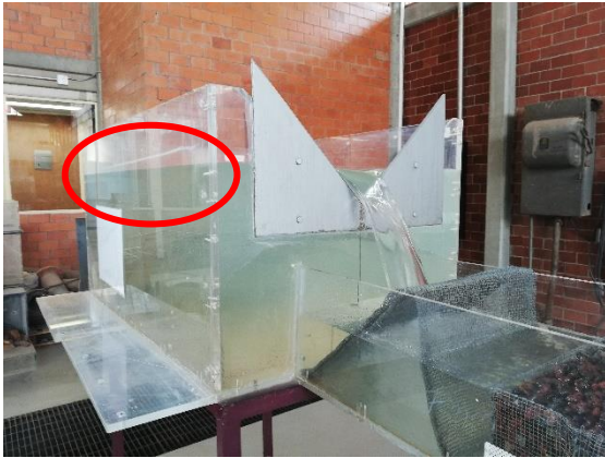
FIGURA 3.2 Tanque con vertedor triangular señalando las etiquetas para la medición de cargas.
