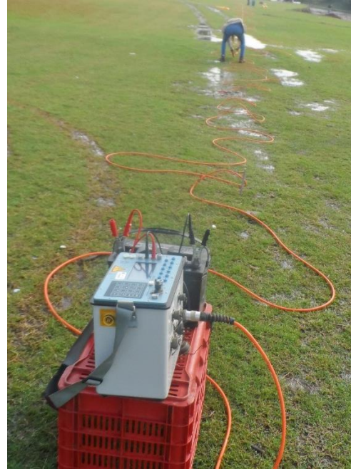
Fig. 2.15 Equipo utilizado en la implementación de Tomografía Eléctrica: (arriba) Sistema Syscal Pro-Iris Instruments junto con una batería externa como fuente; (derecha) arreglo de electrodos conectados mediante cables al Syscal.
