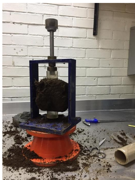
Fig. 3.6 Proceso de toma de muestras inalteradas y la elaboración de probetas a partir de ellas, Col. Del Carmen.
