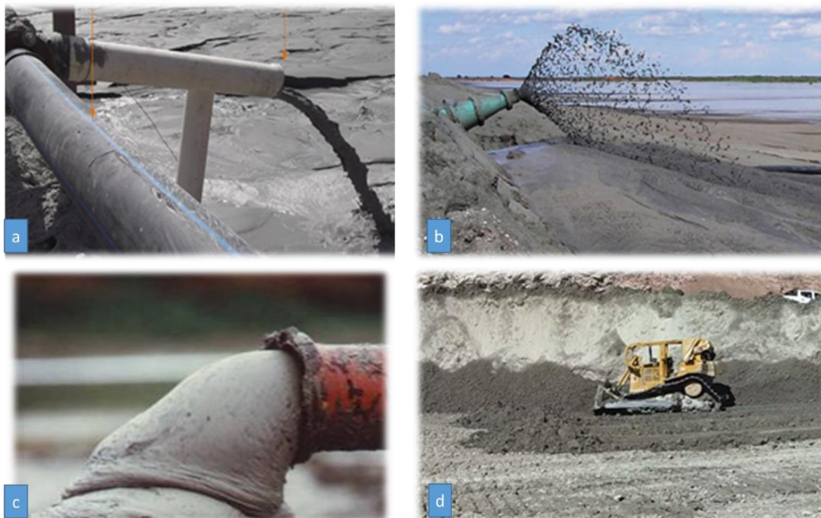
Figura 1-10 Medios de disposición final. a) espigoteo., b) cicloneo, c) jal en pasta y d) jal filtrado (Flores, 2019).
