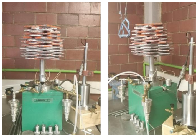
Figura 4-10 Configuración para la calibración del sensor de carga al 100%.
