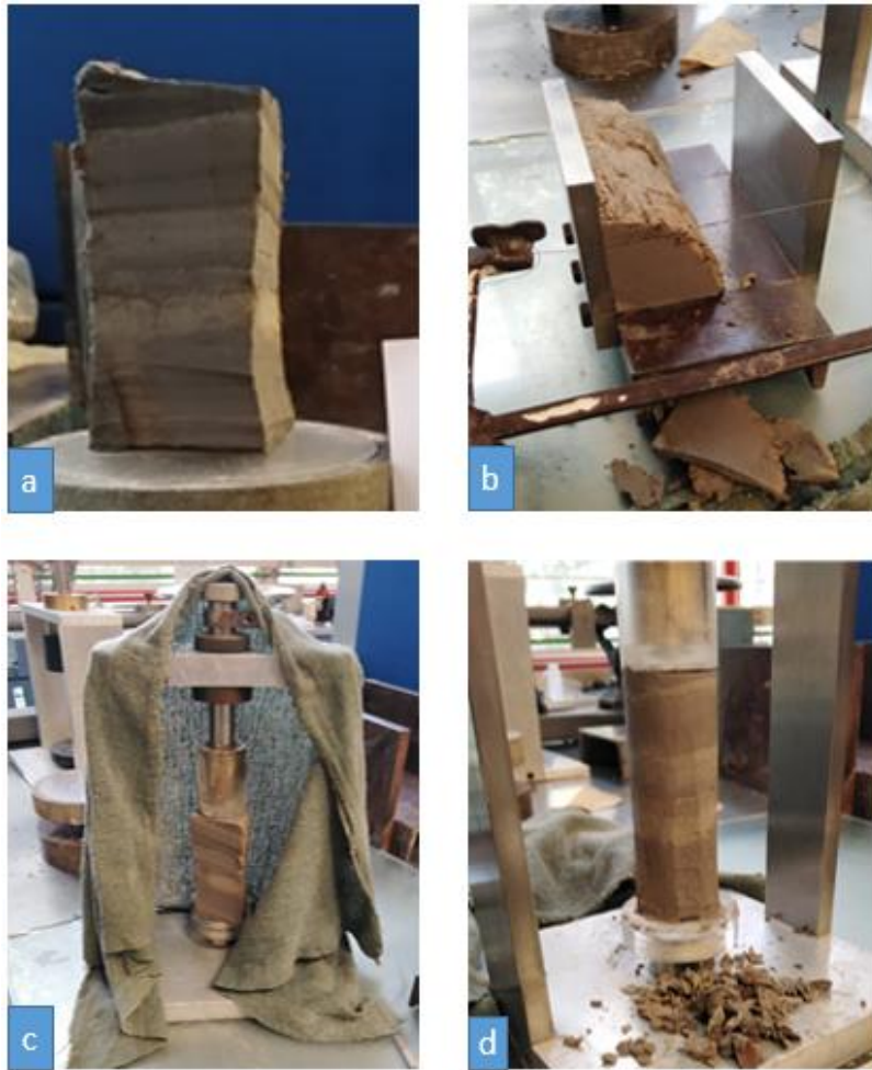
Figura 5-5 Labrado de probeta inalterada.
