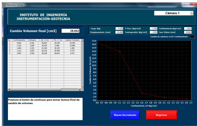
Figura 5-17 Proceso de saturación y registro de datos de acuerdo a cada incremento realizado en una prueba.
