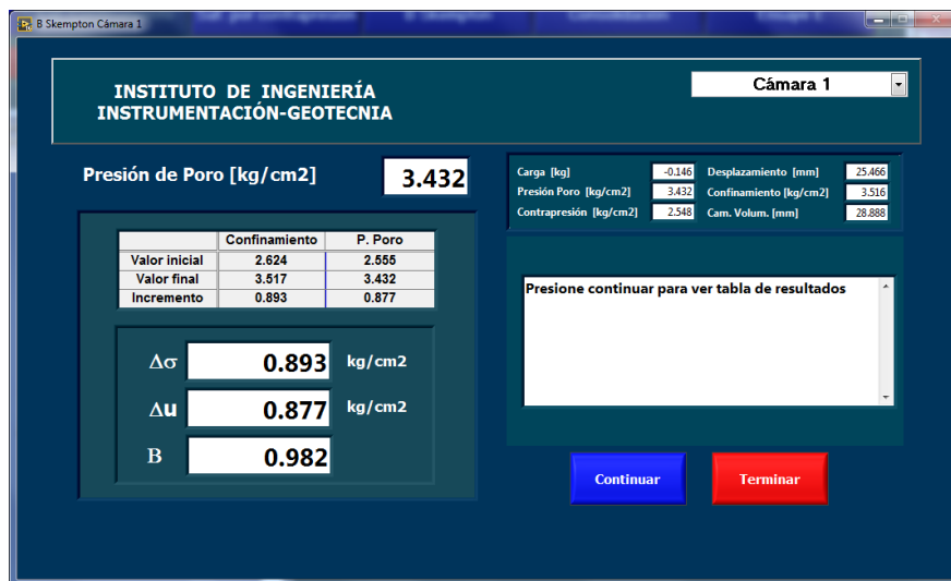
Figura 5-19 Medición del parámetro B de Skempton.
