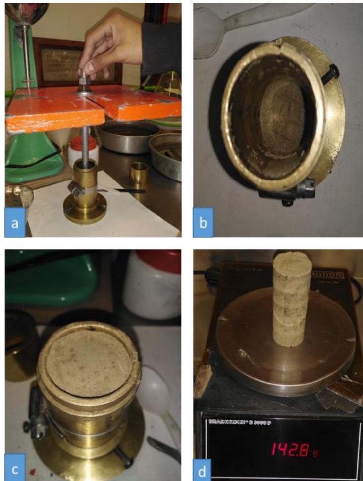
Figura 5-9 Proceso de compactación de probeta reconstituida.
