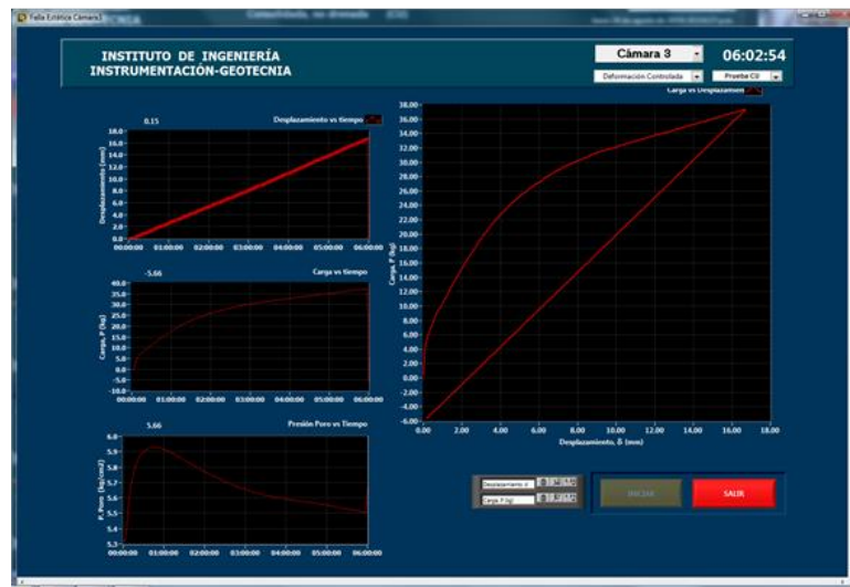
Figura 5-22 Término de la falla estática, donde se muestra la variación del desplazamiento, carga y presión de poro; muestra inalterada de Zacatecas con \sigma' = 2.00 \text{ kg/cm}^2 .
