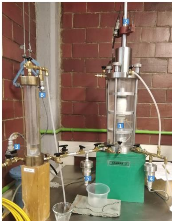
Figura 4-4 Transductores que conforman el sistema de la cámara triaxial cíclica. IIUNAM.
