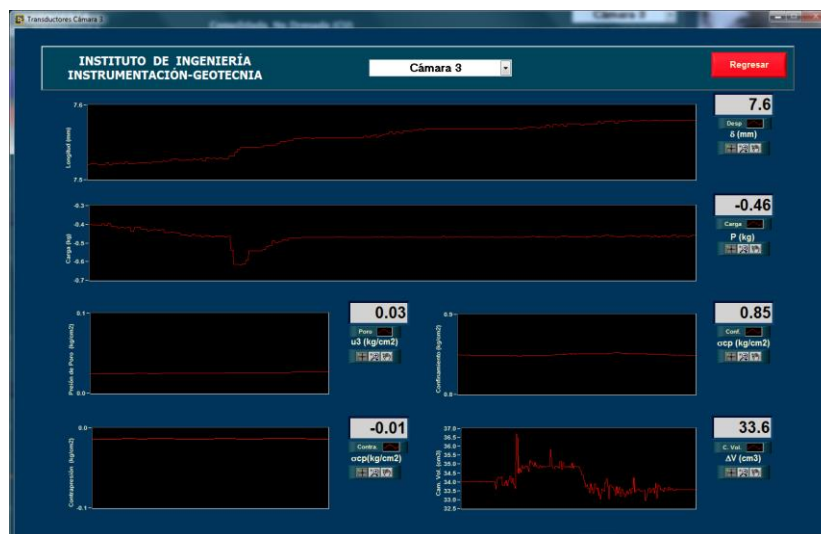
Figura 5-15 Sistema de transductores en tiempo real.
