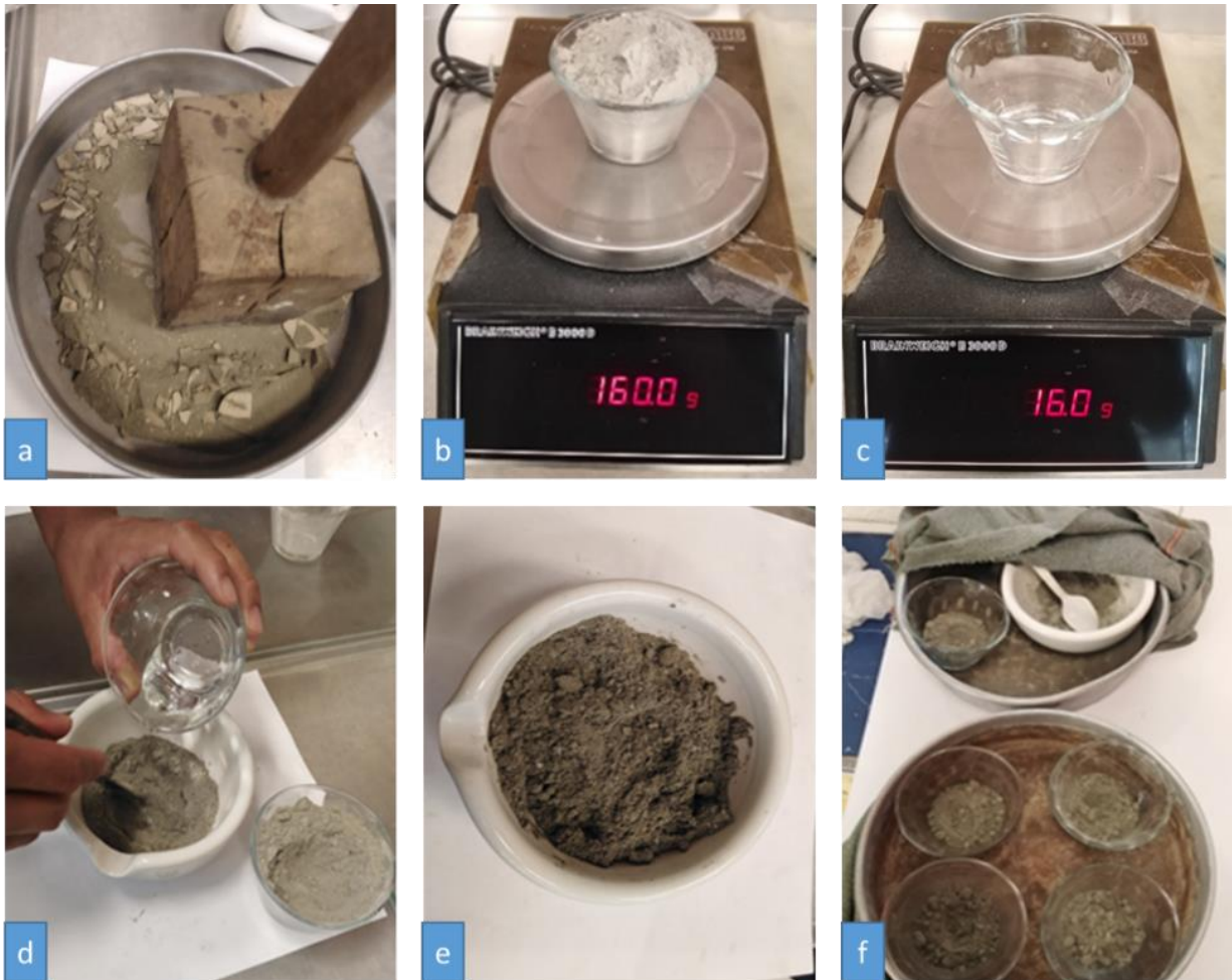
Figura 5-8 Proceso de homogenización y separación por capas del material para reconstitución.
