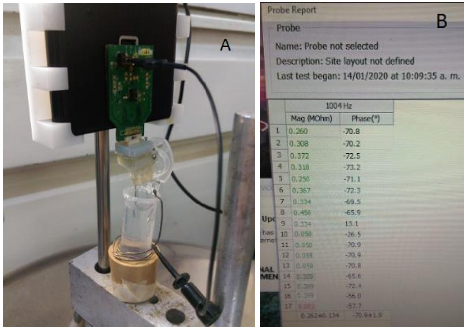
Figura 48. Prueba de impedancia. (A) Montaje de los electrodos. (B) Resultados obtenidos.
