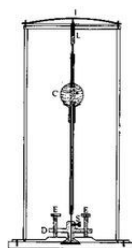
Figura 1.5: Sismógrafo inventado por James Forbes, aplicando los principios del péndulo invertido [41]
