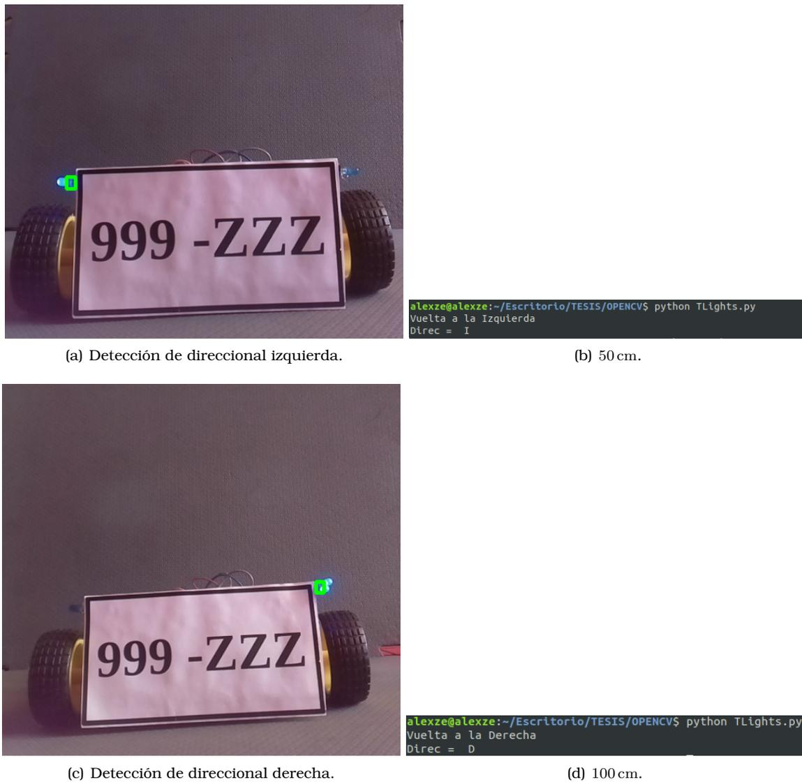
Figura 5.4: Detección de luz direccional.
