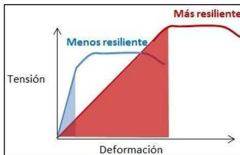
*Figura 1.2 Comparación de graficas esfuerzo deformación de materiales resilientes (Tecnología, 2019).*
