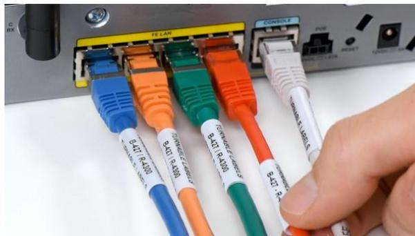
*Figura 3.5.3. Etiquetado de cables.*
