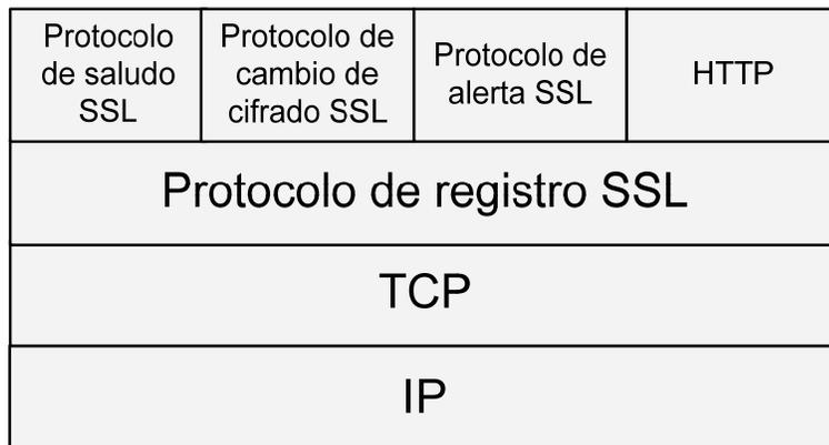
Figura 3. 5 Pila de protocolos SSL.
