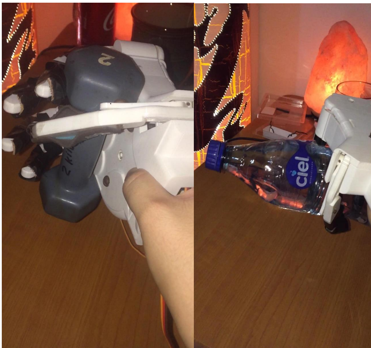
Ilustración 84 Prótesis sujetando una pesa de 2kg y una botella de 600ml
