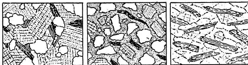
Figura V.5 Comparación entre las texturas del granito, arenisca y esquistos; cada una consiste esencialmente de: cuarzo (claro), feldespatos (ligeramente punteados), y mica (plumeado). A la izquierda, el granito presenta cristales entrelazados; al centro, los granos de arena se hallan en contacto tangencial (el área punteada es la matriz o cementante); a la derecha, mosaico de cuarzo, feldespato y cristales de mica subparalelos.
