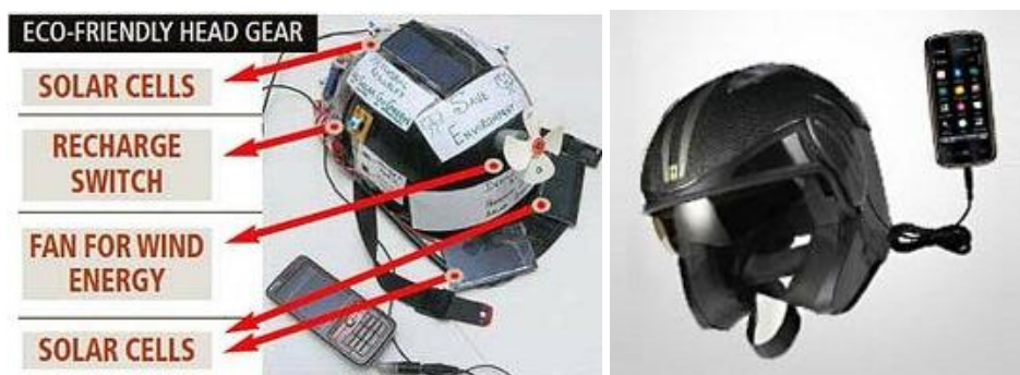
FIGURA 3.18 Casco cargador solar y eólico
