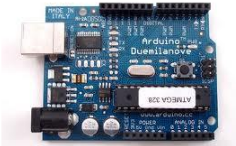
Figura 3.8: Arduino Duemilanove con microcontrolador Atmega328.
