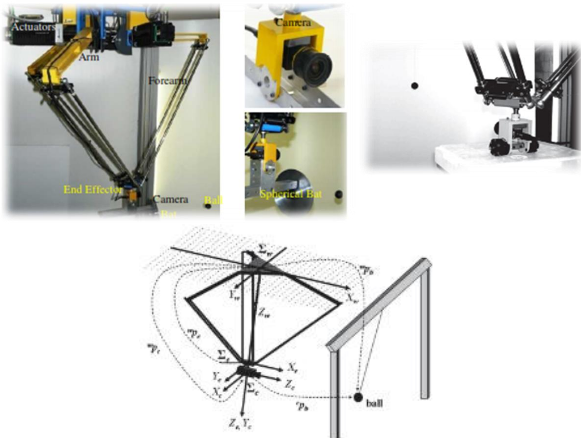
Figura 1.7: Manipulador paralelo inspirado en el robot delta, conocido como “robotenis” de 3 GDL. Desarrollado para el seguimiento de una pelota de ping-pong vía visión.
