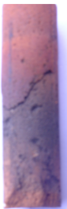
Figura 4.3 a) Especimen con composición 60-40 lodo-arcilla, 1050 °C.
