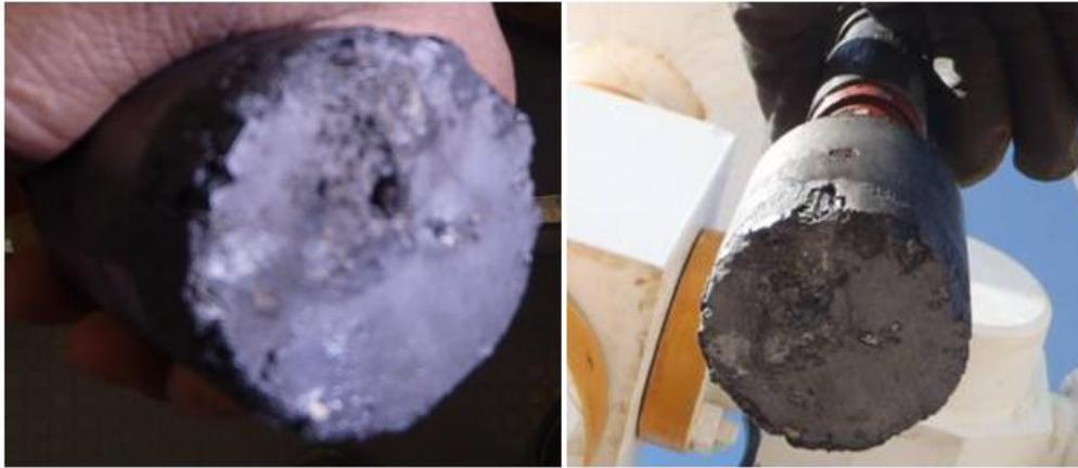
Fig. 5. 3 Sello de plomo después de la calibración.
