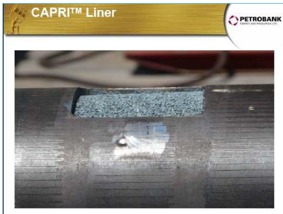
Figura 6 Sección transversal de tubería con empacamiento de catalizador (Cao, E., Greaves, M., Rigby, S.P. 2009)
